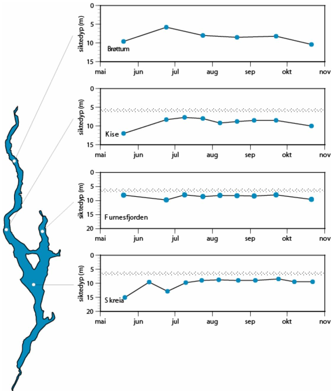
**Figur 2.** Siktedyb ved fire lokaliteter i Mjøsa i 2003. Grå markering angir fastsatt miljøkvalitetsmål for Mjøsa dvs. at siktedypet i Mjøsas midtre (Kise, Furnesfjorden og Skreia) og søndre del (Morskogen) under normale forhold ikke bør være mindre enn 6-7 meter. I Mjøsas nordre del varierer siktedybet mye p.g.a. naturgitte forhold og det er derfor ikke hensiktsmessig å fastsette noe miljøkvalitetsmål i denne del av innsjøen.
