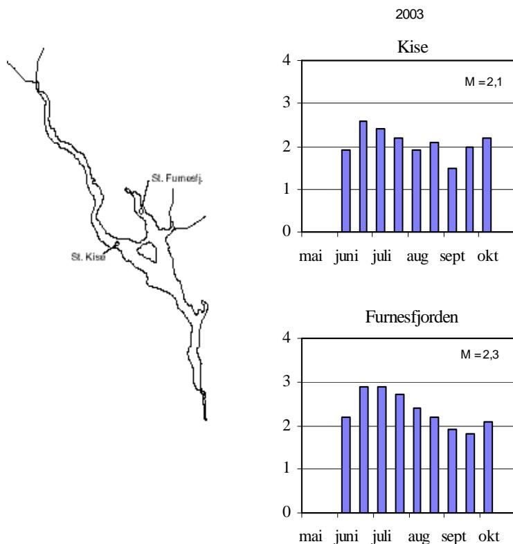
**Figur 5.** Konsentrasjoner av total organisk karbon (TOC) i Mjøsas øvre vannlag (sjiktet 0-10 m) ved stasjonene Kise og Furnesfjorden i 2003. Vurdert ut fra SFTs klassifisering av miljøkvalitet i ferskvann kan tilstanden for TOC betegnes som "God" til "Meget god". Det vil bl.a. si at vannmassene var lite påvirket av humusstoffer eller andre former for organisk karbon.
