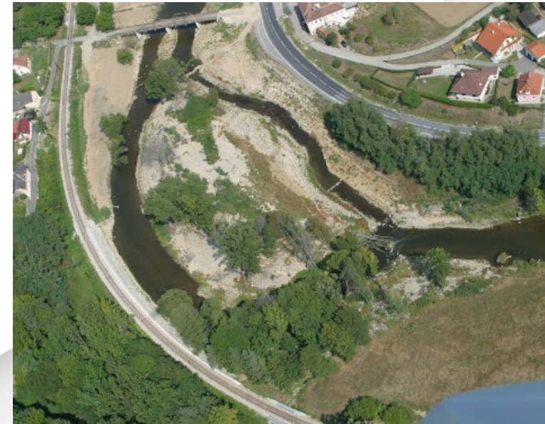
Fig. 2 Settes erosjonsikringen til sidene gjerne også gravd ned i bakken, er det plass til naturtypiske elvebredder og mer flomvann.
