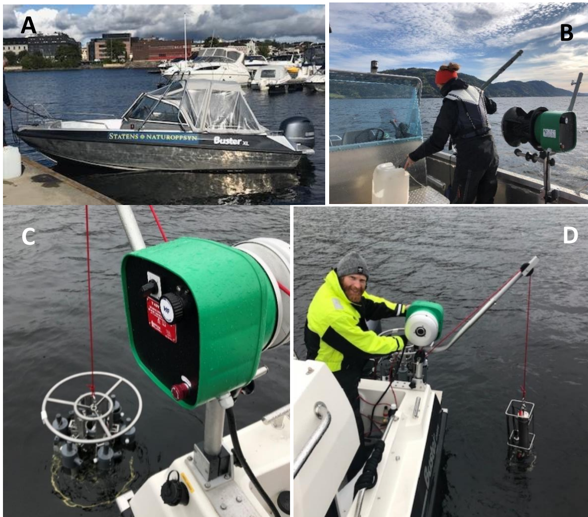
Figur 2. A) Båten fra SNO er utstyrt med løftekran og motorisert linehaler som er egnet til håndtering av tungt feltutstyr, bl.a. rosett-prøvetaker med 6 vannprøveflasker (C) og multisensor-sonde for måling av vertikalprofiler (D). NIVAs egen båt (B) er utstyrt med tilsvarende linehaler og løftekran. Foto: NIVA. Personer i bildet: B) Henriette Kildahl (tidl. NIVA) og D) Jan-Erik Thrane, NIVA.
